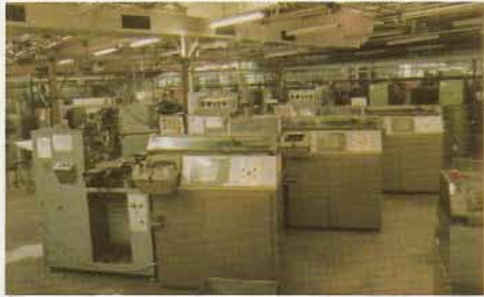
BENZINGER equipment d'usinage au diamant avec chargeur BENZINGER Diamantmaschinen mit automatischer Zuführung
